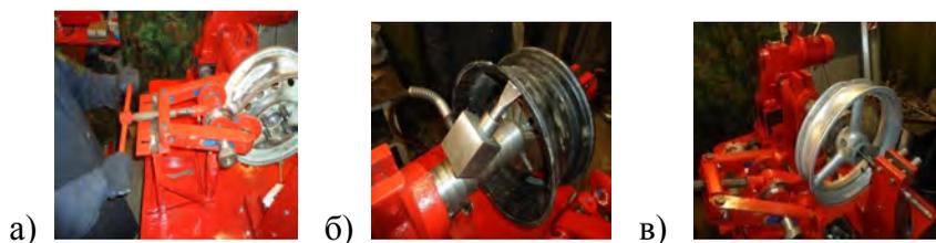
**Рис.5 - примеры установки и правки различных видов дисков – а - ремонт стального штампованного автомобильного диска; б - ремонт литого автомобильного диска; в - ремонт мотоциклетного литого диска.**
