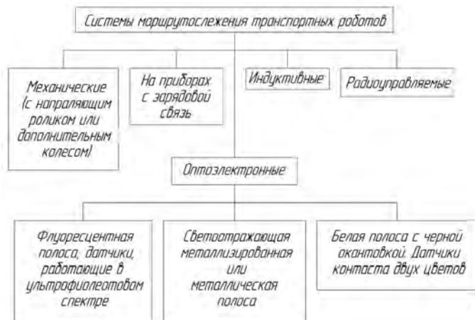
Рис. 3. Классификация систем маршрутослежения транспортных роботов.
