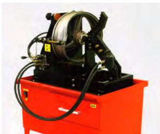
**Рис. 4. Стенды правки мотоциклетных дисков Лидер.**
