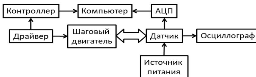
Рис. 4. Функциональная схема экспериментального стенда для исследования характеристик датчика
