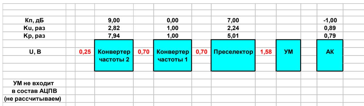
Рис. 7. Результаты расчета коэффициентов усиления тракта в режиме передачи сигналов
