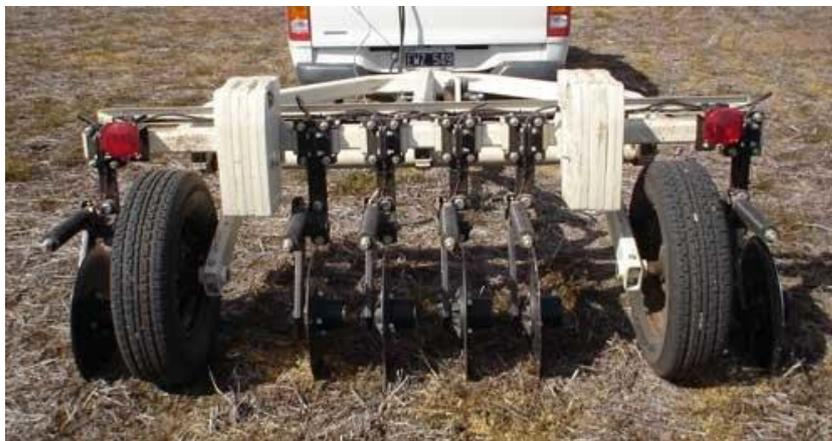
Рис. 4. Устройство измерения электропроводности
