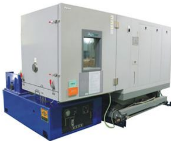
Рис. 3. Двухосевой динамический стенд с интегрированной климатической камерой
