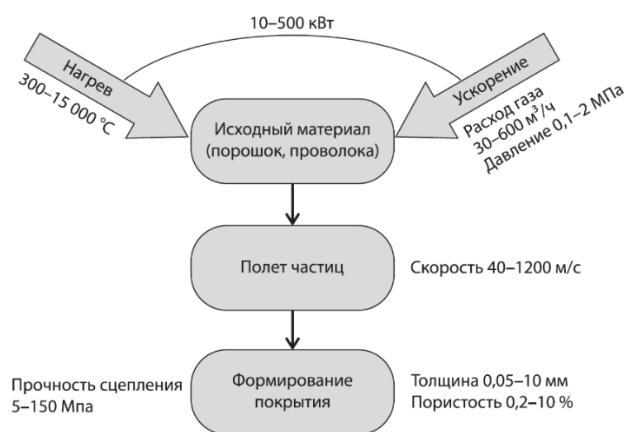
Рис. 1. Схема процесса газотермического напыления
