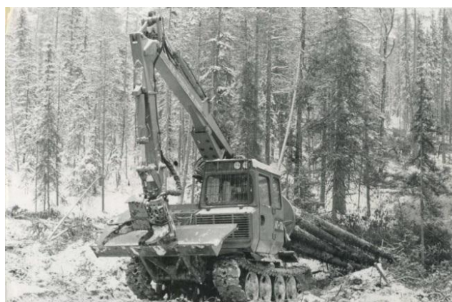
Рис. 4. Транспортно-технологическая машина (ЛП-17А) для разубки противопожарных просек (и рубок главного пользования), обеспечивающих безопасность лесных поселений, а также самих лесонасаждений
