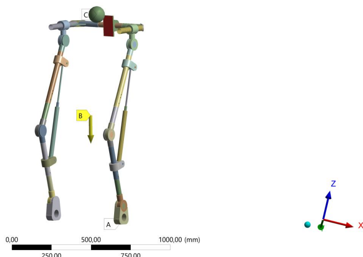
Рис. 4. Закрепления и нагрузки, приложенные экзоскелету
