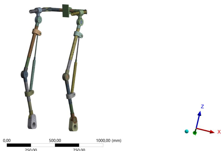
Рис. 2. Конечно-элементная модель изделия «Экзоскелет»
